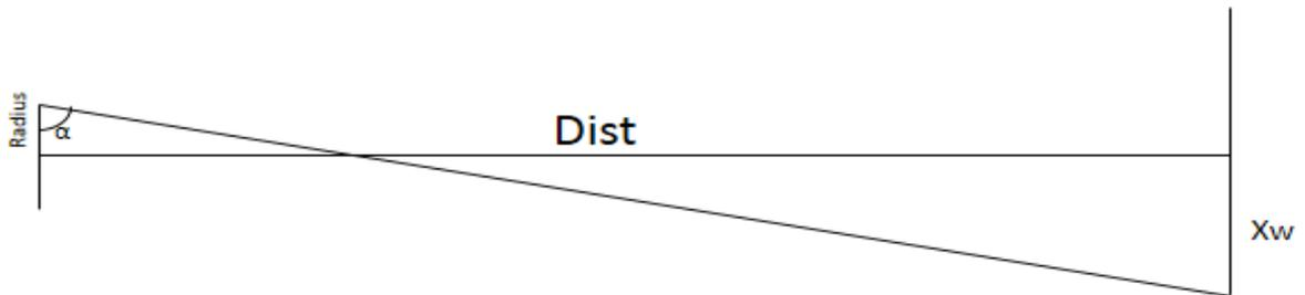
Figura 25 Schema per il calcolo della divergenza angolare del fascio neutronico
