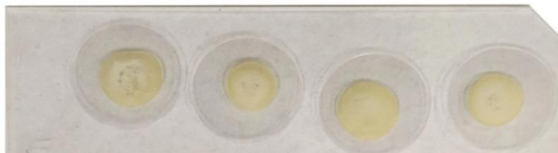
Figura 23: Preparazione di campioni contenenti cellule su CR-39 per essere sottoposti ad irraggiamento
