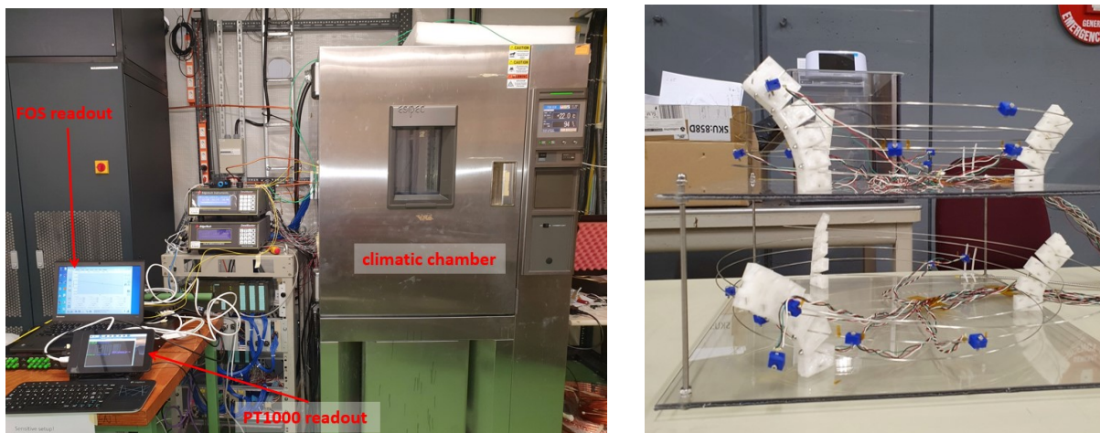
Figura 3.1. Strumentazione adottata per il processo di calibrazione (a sinistra) e fibre con sensori di temperatura (a destra).
