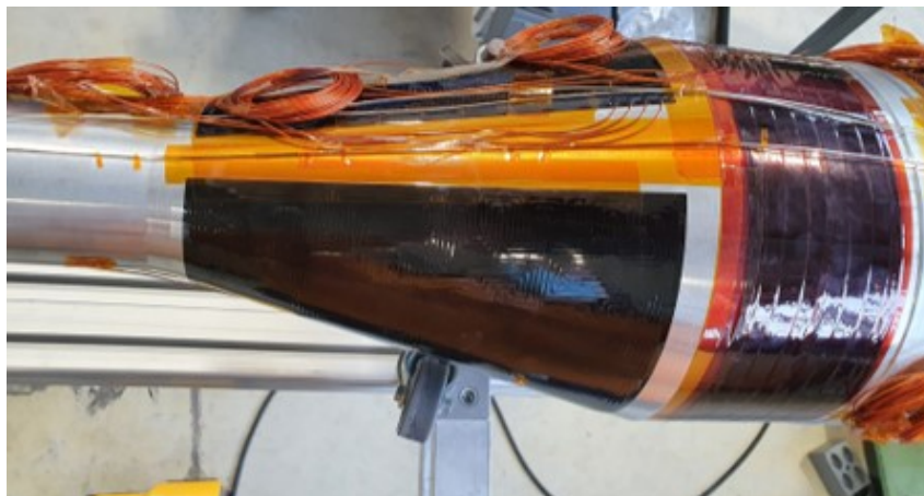
Figura 2.10. Imballaggio con i fogli di Kapton.
