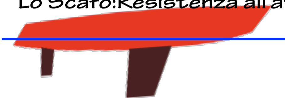
Lo scafo sotto l'azione della componente propulsiva aumenta la sua velocità sino a quando la resistenza all'avanzamento non produce una forza uguale e contraria  $R_a$
