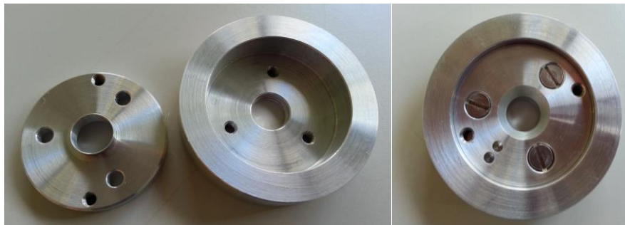
Figura 4. Fotografia del porta-bersaglio realizzato presso l'officina meccanica dei LNL.
