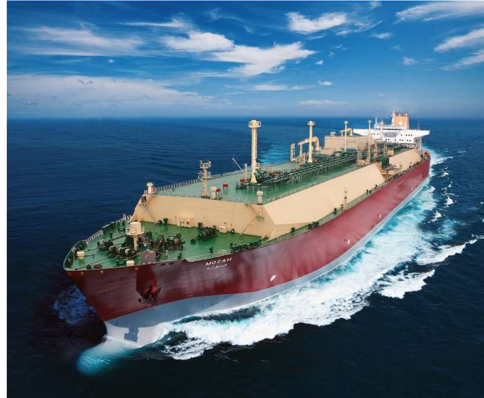
266,000 m 3 MOZAH (biggest tank in the world) Q-MAX LNG CARRIER
