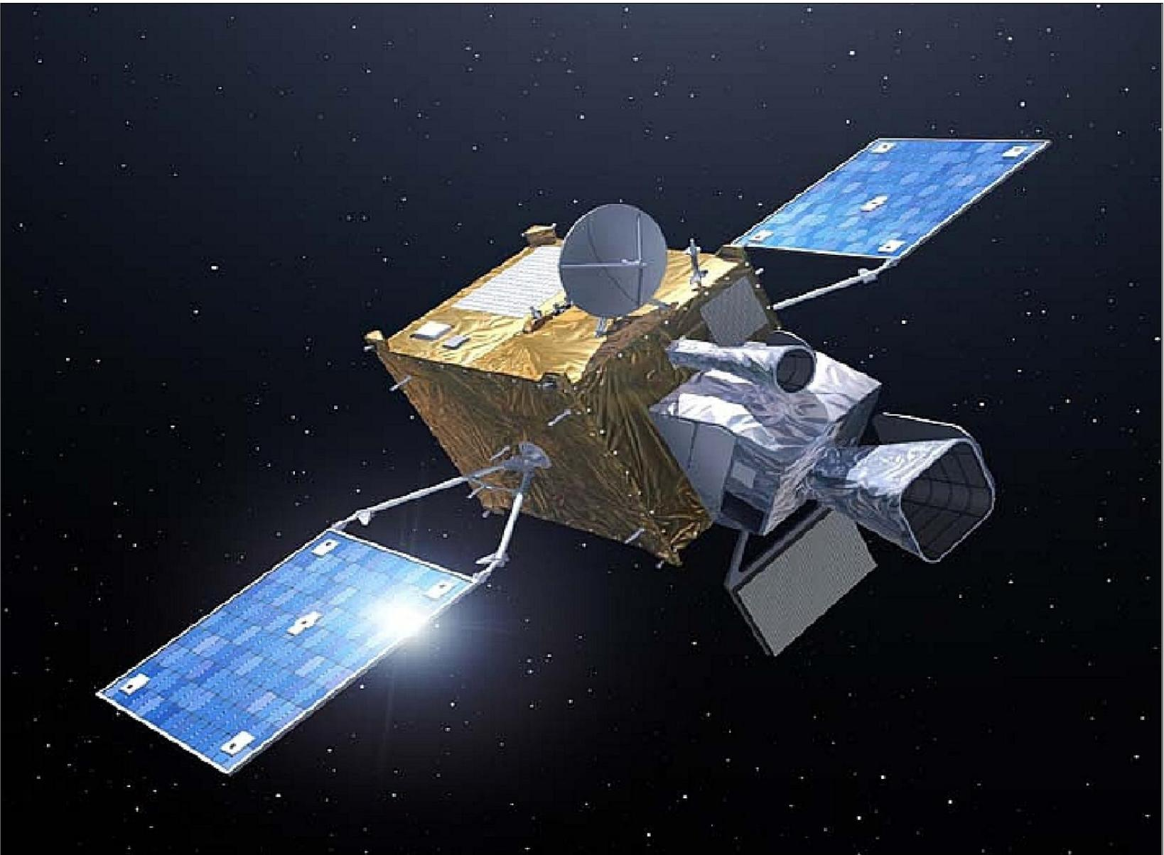
Il FCI ( Flexible Combined Imager ) acquisisce contemporaneamente 16 canali nello spettro visibile ed infrarosso di cui otto sono fra  $0.4\mu\text{m}$  e  $2.2\mu\text{m}$  e forniscono dati con una risoluzione spaziale di 1 Km al nadir. Gli altri otto si trovano nella zona “termica” dello spettro, ovvero tra  $3.8\mu\text{m}$  e  $13.3\mu\text{m}$ , e forniscono dati con risoluzione spaziale di 2 Km al nadir
