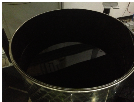
Figura 3.26: Foto della water tank rivestita con il PVC nero.
