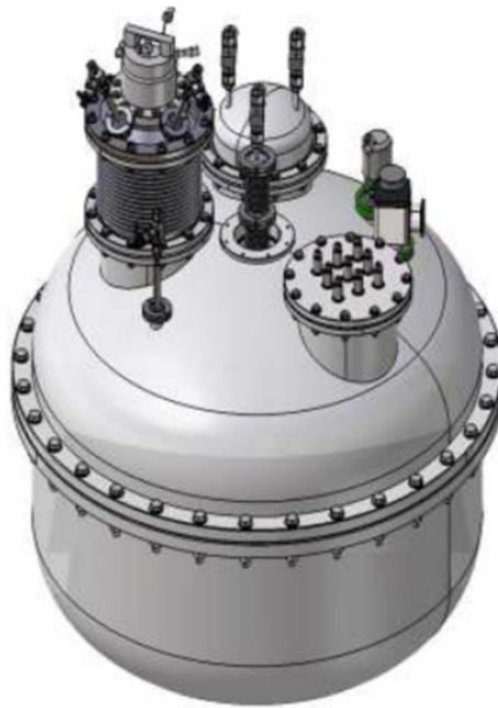
Figura 2.9: Tanica per l'immagazzinamento dello Xenon liquido.
