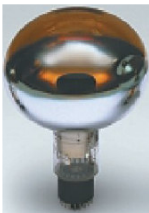
Figura 2.14: Foto di un PMT Hamamatsu R5912
