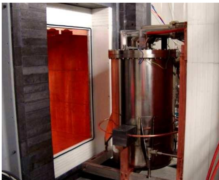
Figura 20: Immagine del rivelatore a schermi aperti.
